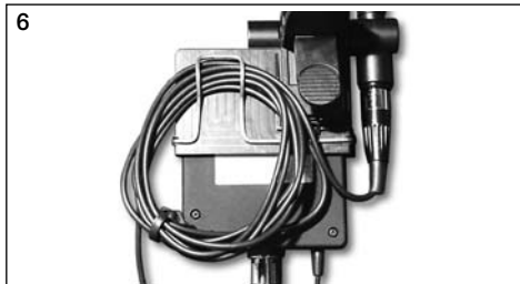
Fig. 4: Enrolar e fixar o cabo de conexão
