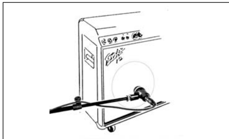
Fig. 3: Posizionamento del microfono per amplificatore per chitarra
