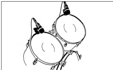
Fig. 5: Posicionamento do microfone para tom-toms ou roto-toms.
