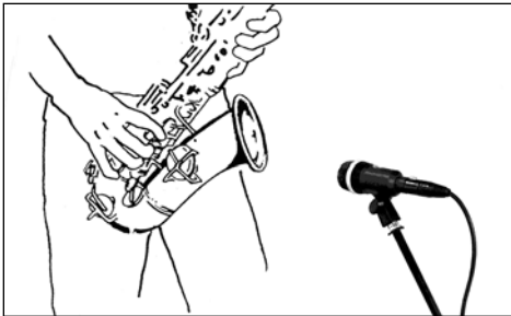
Fig. 1: Posizionamento del microfono per sassofono
