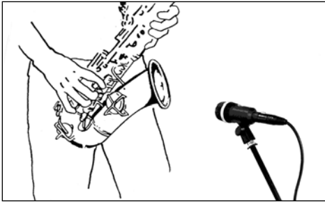
Fig. 1: Posicionamento do microfone para o saxofone.
