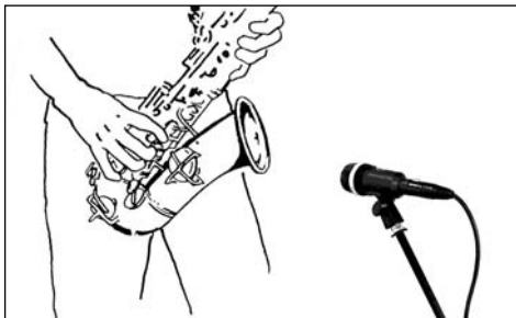
Fig. 1 : Position du microphone pour le saxophone
