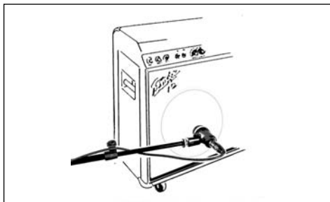
Fig. 3 : Position du micro pour amplis pour guitare
