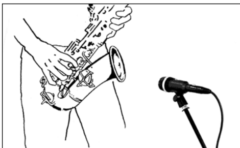
Abb. 1: Mikrofon-aufstellung für Saxophon
