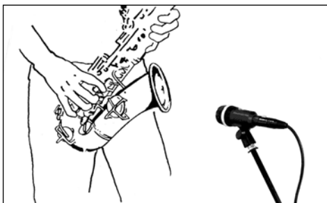
Fig. 1: Emplazamiento del micrófono para saxófono
