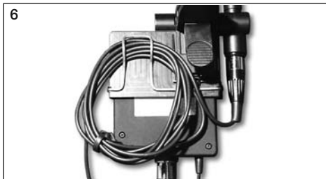
Fig. 4: Enrollar el cable de conexión y fijarlo
